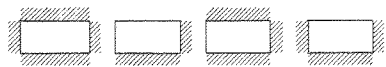
Fig. 4. Hyppigt forekommende understøtningsbetingelser for jernbetonplader i boliger; skravering langs en kant markerer indspænding.
